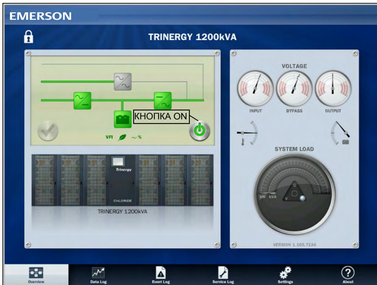
Рис. 9 - Вид экрана системы в режиме VFI
