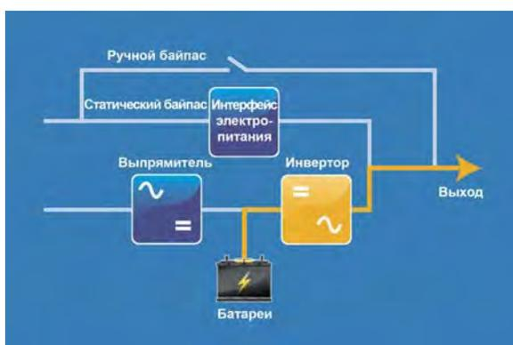
Рис. 4 - Работа в аккумуляторном режиме
