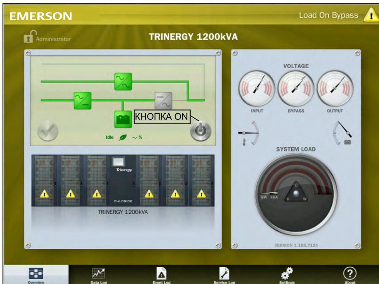
Рис. 8 - Вид экрана системы в режиме байпаса с включенным выпрямителем (ON).
