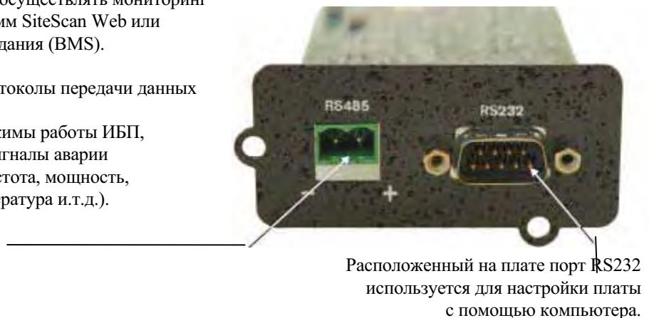
Расположенный на плате порт RS232 используется для настройки платы с помощью компьютера.
