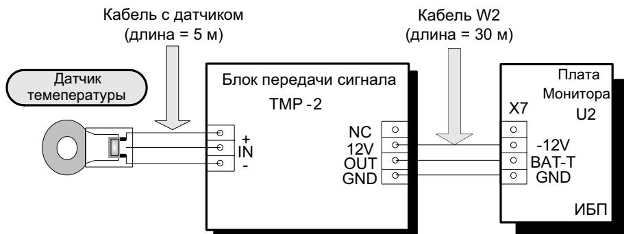
*Рисунок 6 – Подключение комплекта датчика контроля температуры к ИБП*
