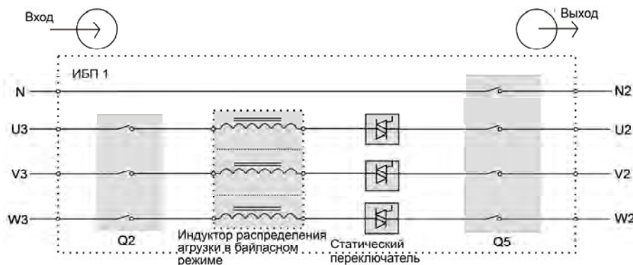
Рисунок 8-1 Принцип действия индуктора распределения нагрузки в байпасном режиме
