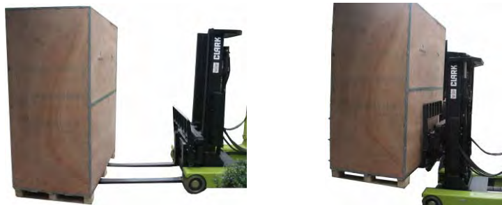
Рисунок 2-1 Положение вилок погрузчика во время перемещения оборудования
