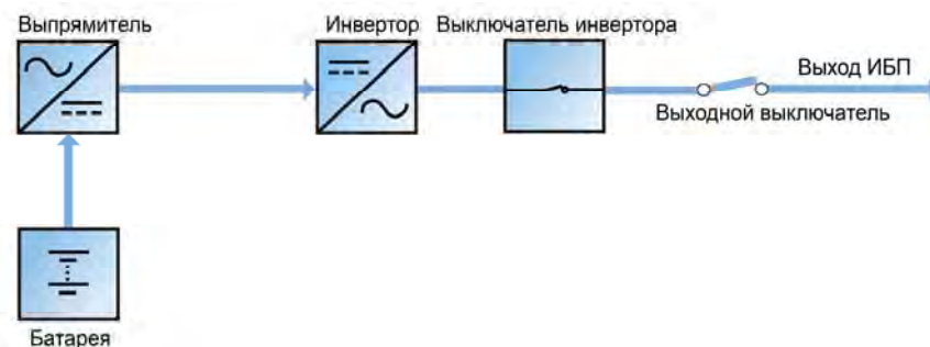
Рисунок 1-4 Схема режима работы от батареи
