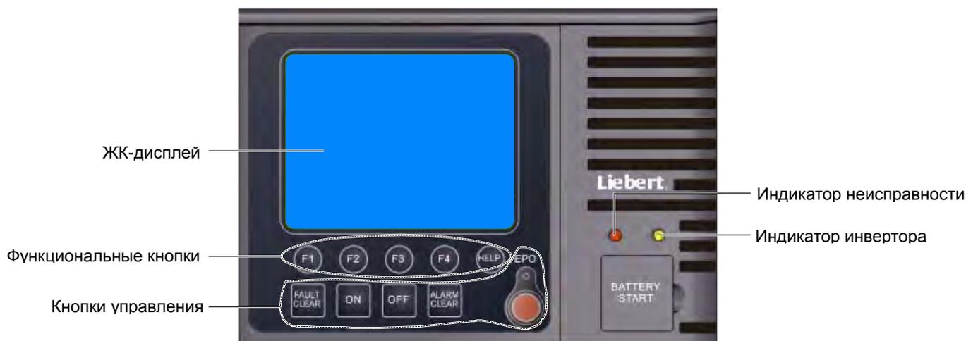
Рис. 5-1 Панель управления с дисплеем
