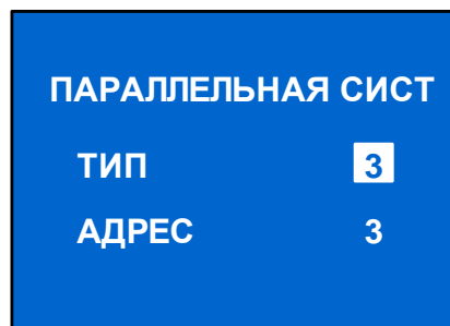
Изображение 25 Экран параллельной системы — только для устройств 10 кВА.
