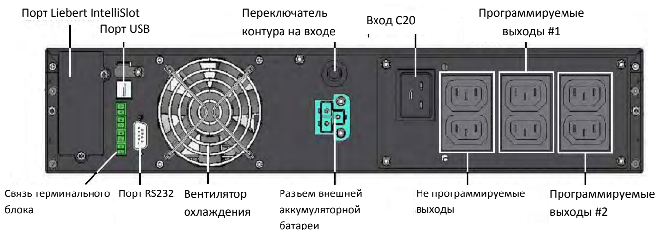
Рис. 4 Задние компоненты, модели Liebert GXT4 230V 2000VA
