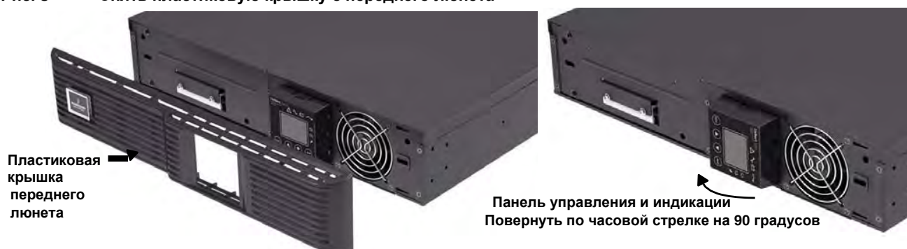
Рис. 8 Снять пластиковую крышку с переднего люнета
