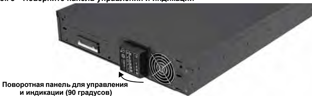
Рисунок 8 Поверните панель управления и индикации
