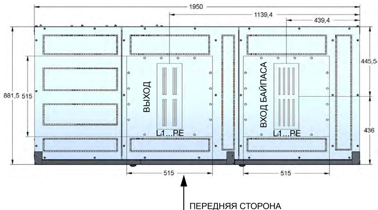
Рисунок 33 - РАЗМЕРЫ БЛОКА ВВОДА-ВЫВОДА 4000-5000 А (ВИД СВЕРХУ С ФЛАНЦАМИ)
