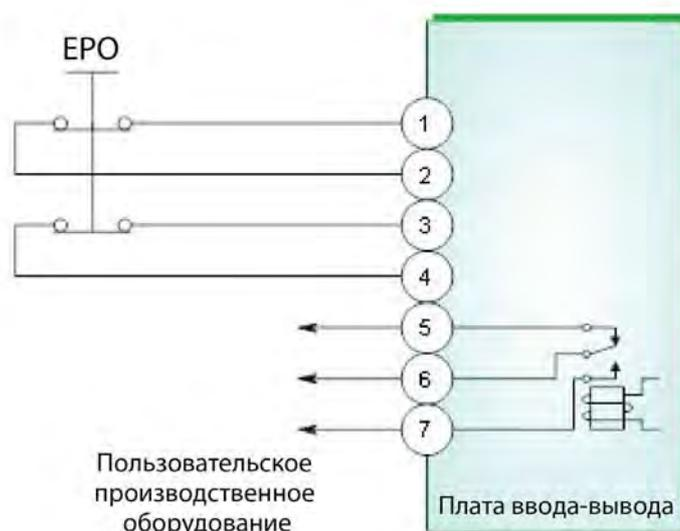
Рисунок 118 - Подключение разъема XP10
