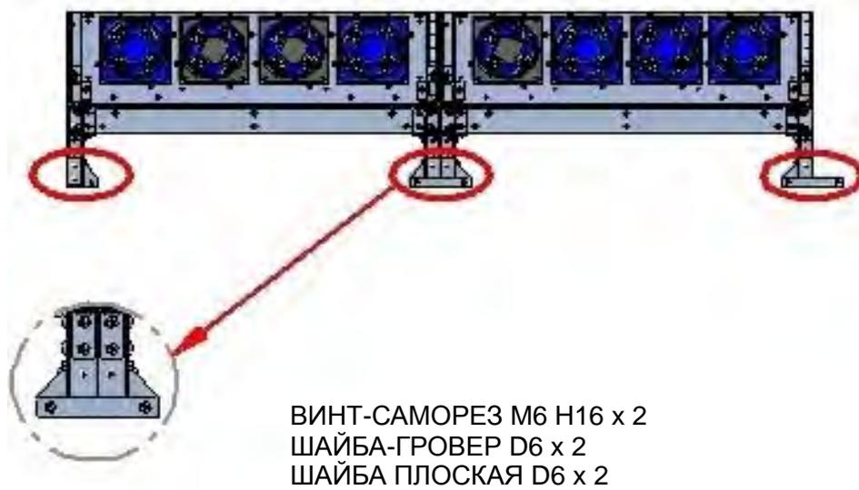
Рисунок 54 - Сборка НИЖНЕЙ ЧАСТИ – МОДУЛЬ с МОДУЛЕМ
