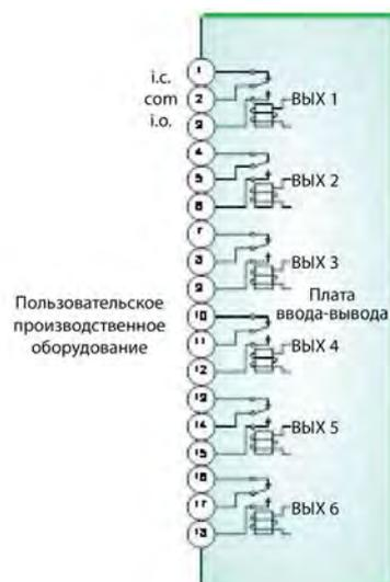
Рисунок 120 - Подключение разъема XP12
