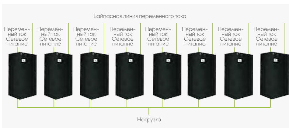
Распределенная параллельная конфигурация Liebert EXL из 8-ми параллельных ИБП
