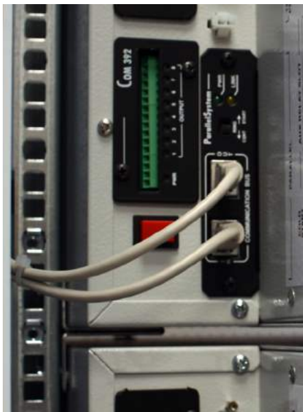
Параллельное подключение и плата контактов программируемых реле
