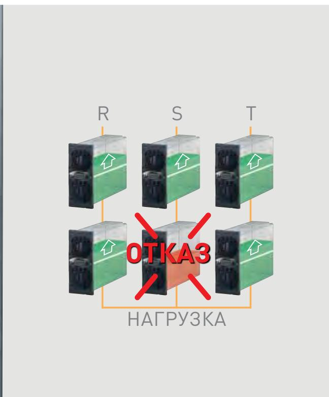
Блочная модульная архитектура позволяет заменять отдельные элементы, не прерывая работы всей системы.
