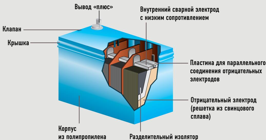
Кроме того, свинцово-кислотные батареи обеспечивают высокий ток и непрерывную работу даже без необходимости достижения полного разряда – в отличие от АКБ других типов, они не подвержены т. н. «эффекту памяти».
