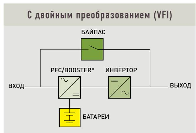
\* СХЕМА КОРРЕКЦИИ КОЭФФИЦИЕНТА МОЩНОСТИ, ВЫПРЯМЛЕНИЯ И ЗАРЯДКИ (PFC – КОЭФФИЦИЕНТ КОРРЕКЦИИ МОЩНОСТИ)
