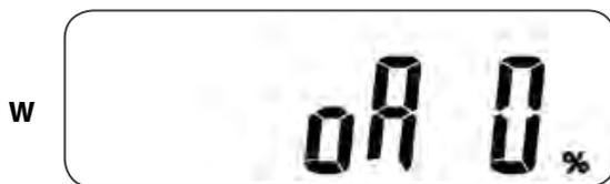
\* Регулирование выходного напряжения: от + 0 % до + 3 % или от - 0 % до - 3 %
