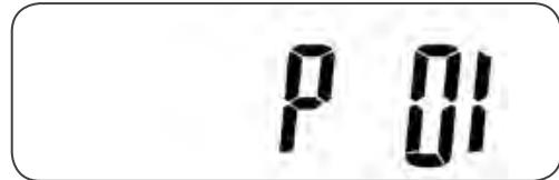
\* ИБП под № 1 в параллельной системе
