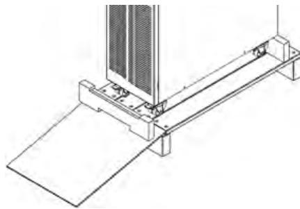
**Открутите крепежные винты стопоров на поддоне спереди и сзади ИБП. Снимите стопоры.**
