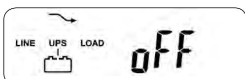
\* "OFF" (ОТКЛ) означает «неудачный пуск ИБП».
