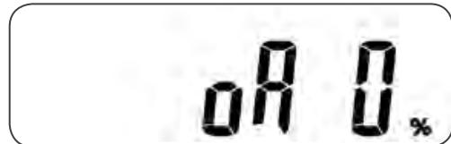
\* Регулирование выходного напряжения: от + 0 % до + 3 % или от - 0 % до - 3 %
