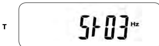
\* Диапазон синхронизации частоты +/- 3 Гц.
