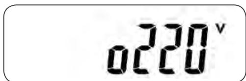
Работа в нормальном режиме Online (norl) возможна, когда напряжение и частота сети находятся в допустимом диапазоне. Допустимые пределы подачи питания в сети, обеспечивающие нормальную работу ИБП, представлены в [Приложении З «Технические характеристики»](#).
