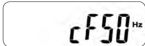
\* ИБП работает в режиме преобразования частоты: 50 Гц.
