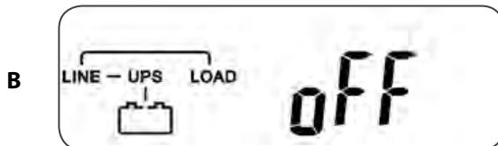
ИБП сразу перейдёт в режим байпаса и автоматически выполнит самотестирование. Если на дисплее никаких аварийных сообщений не появится, то предварительный пуск ИБП в работу выполнен успешно и зарядное устройство начало заряжать батареи.
