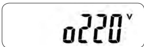
Работа в нормальном режиме Online (norl) возможна, когда напряжение и частота сети находятся в допустимом диапазоне. Допустимые пределы подачи питания в сети, обеспечивающие нормальную работу ИБП, представлены в Приложении 3 «Технические характеристики».
