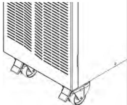
**Выкатите ИБП с поддона. Разместите ИБП на месте монтажа.**
