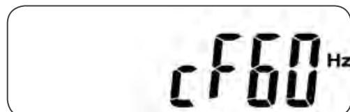
\* ИБП работает в режиме преобразования частоты: 60 Гц.
