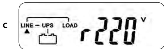
ИБП снова включит режим самотестирования. Экран С сменится экраном D и ещё около 4 сек. ИБП будет работать в автономном режиме. Затем, если самотестирование пройдёт успешно, то экран E1 сменится экраном F.
