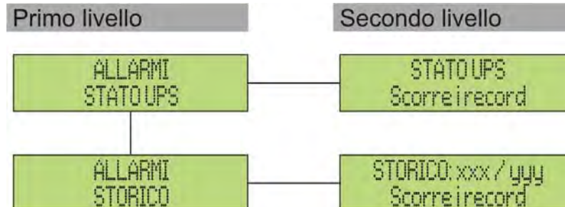
Figura 10 – Struttura menu allarmi
