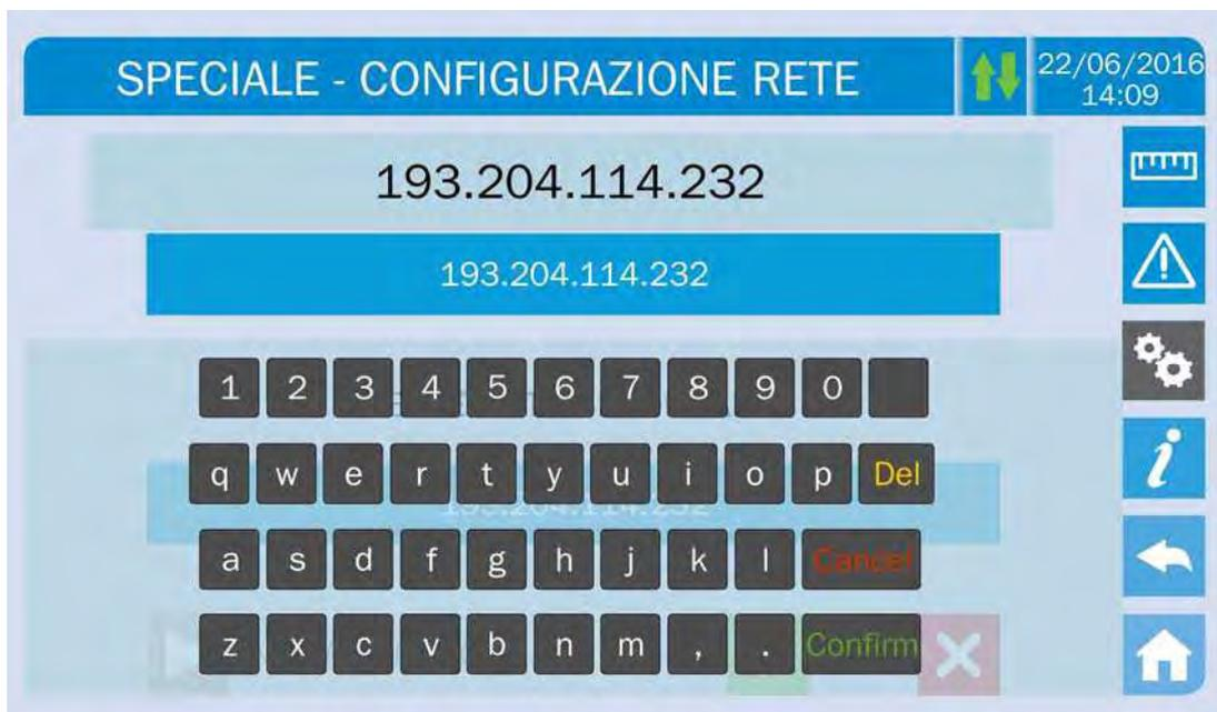
Figura 28 – Modifica parametri indirizzi NTP
