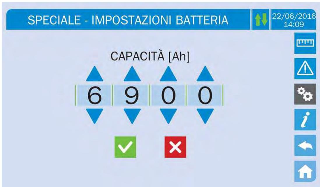
Figura 23 – Impostazione capacità batteria centralizzata
