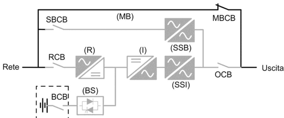
Figura 7 – By-pass manuale per manutenzione o riparazione
