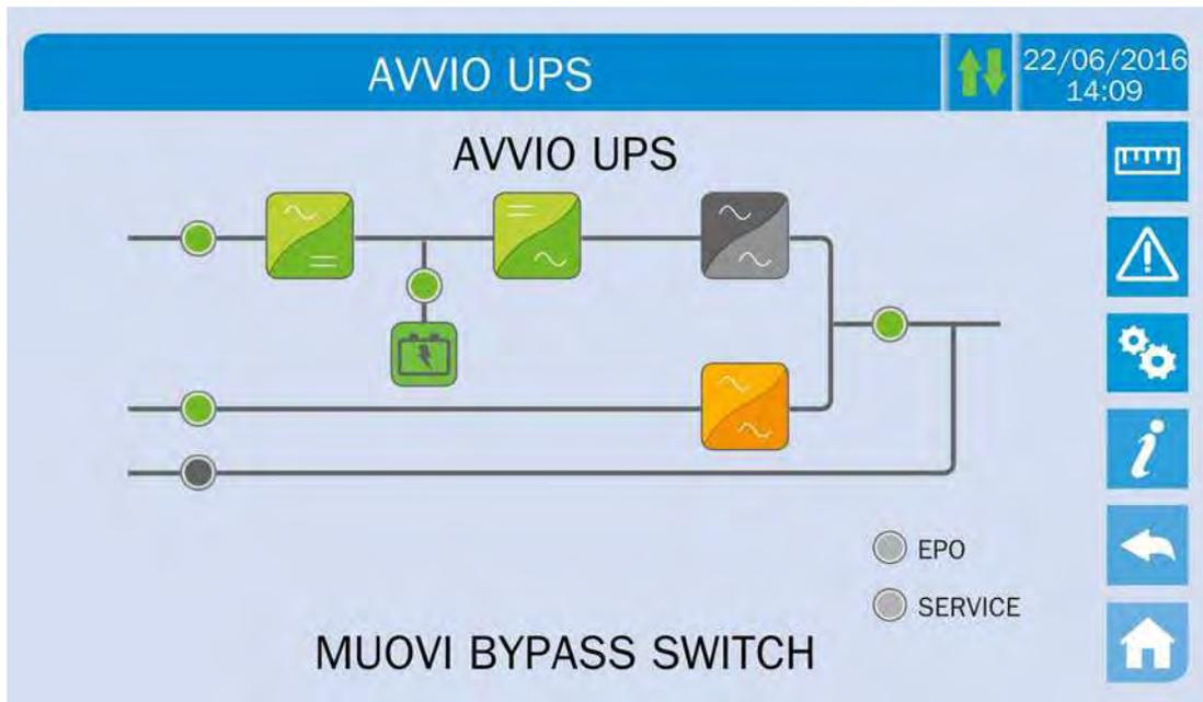
Figura 23 – Trasferimento del carico
