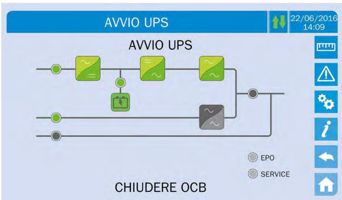
Figura 15 – Connessione dell'UPS al carico
