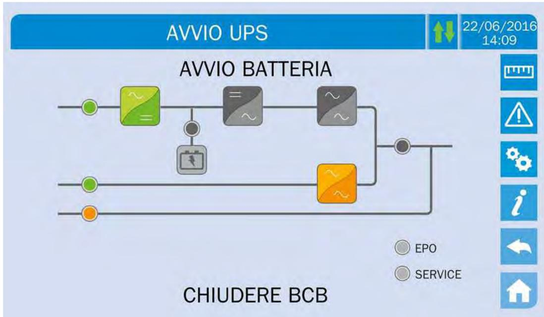
Figura 19 – Connessione della batteria
