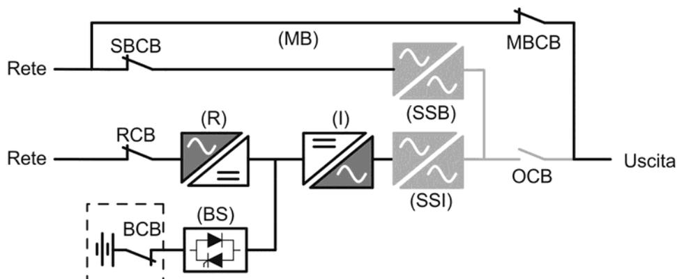
Figura 6 – Bypass manuale per prove funzionali
