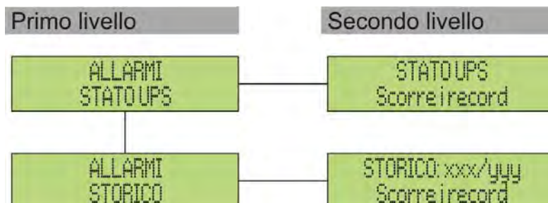
Figura 13 – Struttura menu allarmi
