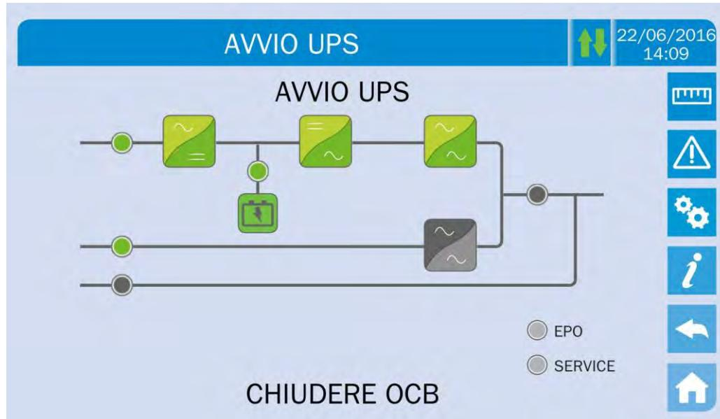
Figura 15 – Connessione dell'UPS al carico
