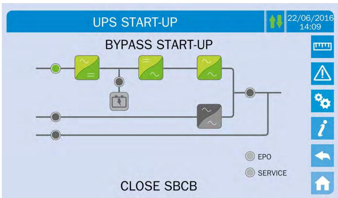
Figura 20 – Chiusura del sezionatore uscita UPS
