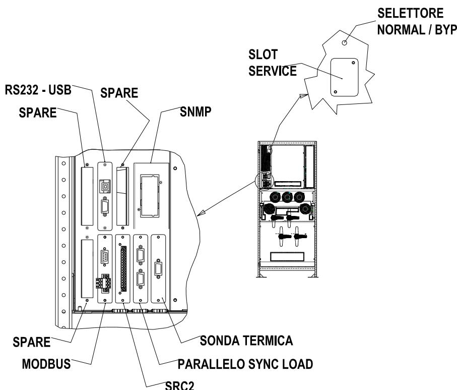
Figura 8 – Posizione schede di interfaccia KEOR HPE 200-250-300kVA
