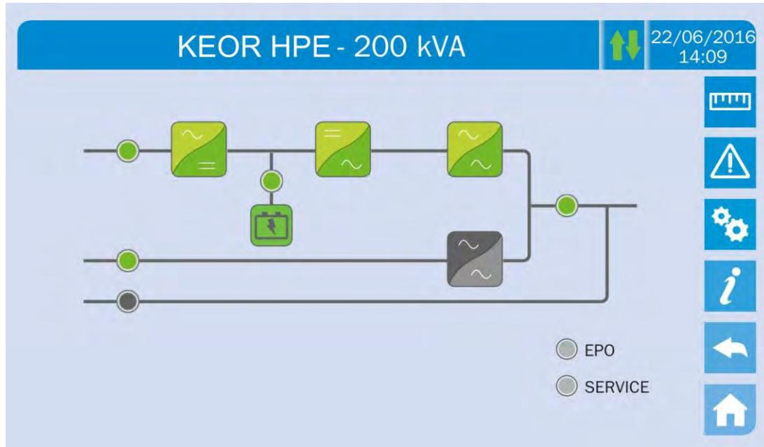
Figura 24 – Avvio da bypass manuale completato
