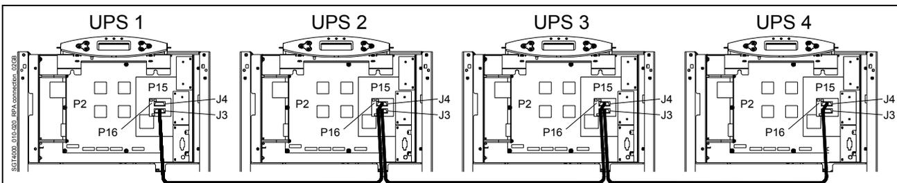
Рис. 4.8.4-2 Соединения шины параллельной системы RPA
