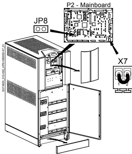
К колодке **X7 / 1, 2** на **P2 – Основной плате** может быть подключен внешний Аварийный выключатель (*NC* – нормально замкнутый, свободный от напряжения)
