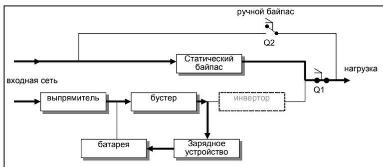
Рис. 3.2-2 Поток энергии в режиме IEM
