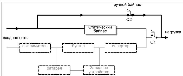
Рис. 3.2-5 Поток энергии при работе сервисного байпаса.
