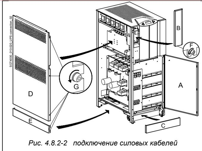
Рис. 4.8.2-2 подключение силовых кабелей
