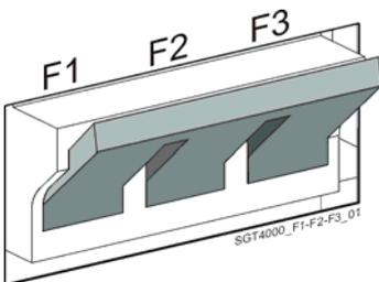
Рис. 6.2-3 Предохранители выпрямителя
