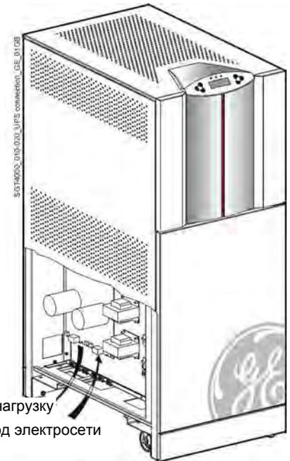
**Рис. 5.1.1-6. Подключение силовых кабелей**
