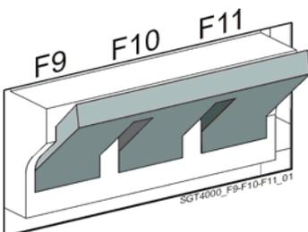
Рис. 6.2-4 Предохранители батареи
