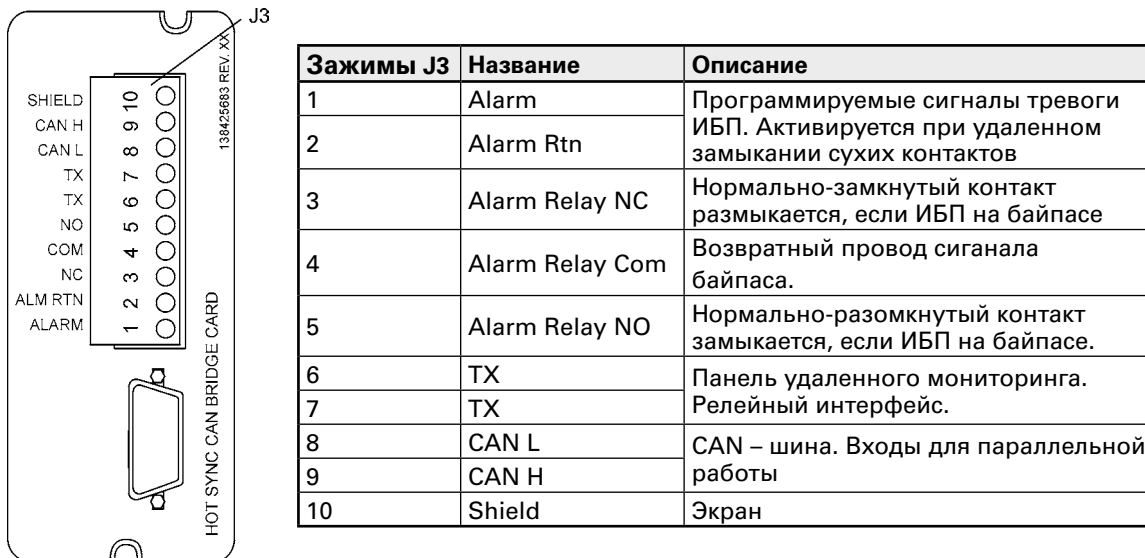
Рисунок 44. Плата XSlot Hot Sync и контактный интерфейс
