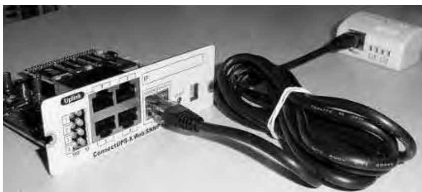
Рисунок 25. Модуль ConnectUPS-X Web/SNMP и датчик мониторинга окружающей среды
