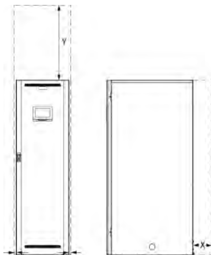
Рисунок 11. Свободное пространство для шкафа ИБП
