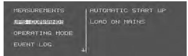
Команда "load on mains" («перевод нагрузки на питающую сеть») предназначена для ручного перевода нагрузки с питания от инвертора на питание от незащищенной электросети при помощи статического переключателя.
