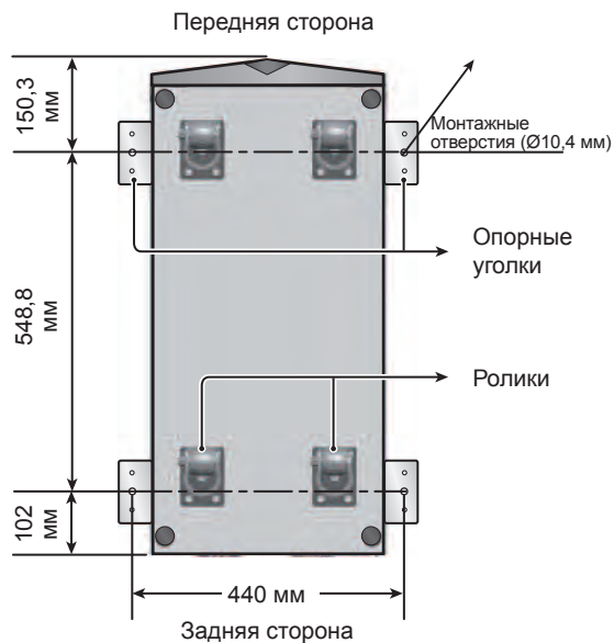
Рис. 6-2. Расположение крепежных отверстий
