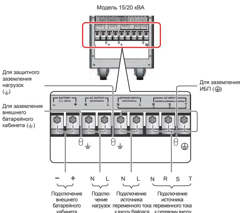
Рис. 6-16. Схема подключения одиночного ИБП 15/20 кВА в конфигурации с двумя входами
