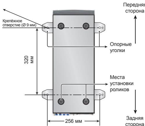
*Рис. 6-1. Расположение крепёжных отверстий ИБП 10 кВА*
