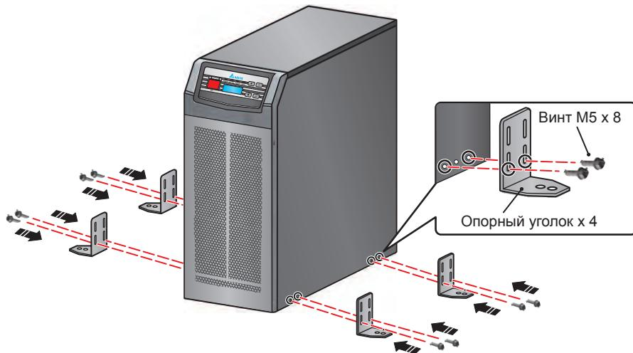
Рис. 6-2. Установка опорных уголков ИБП 10 кВА
