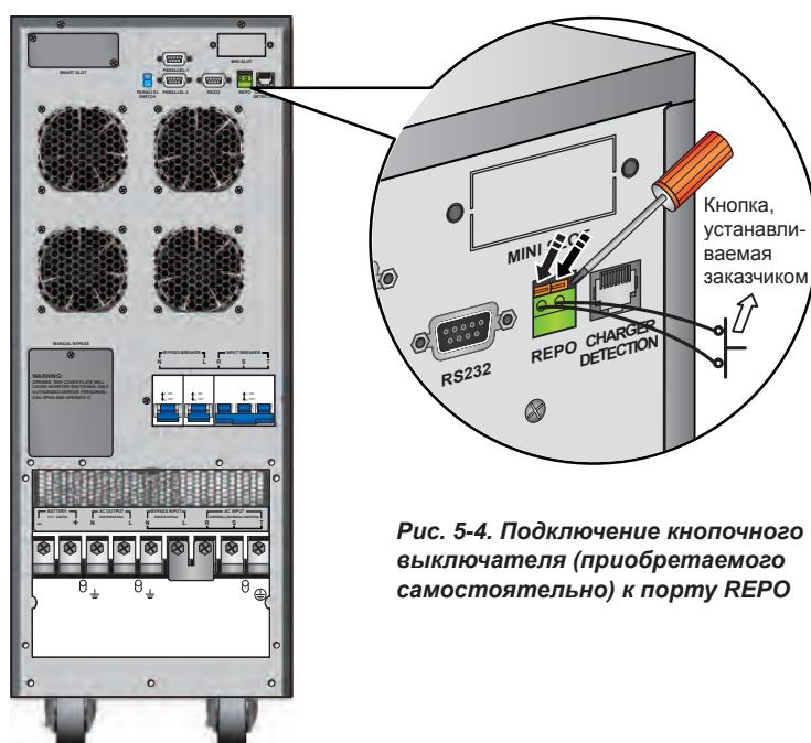
Рис. 5-4. Подключение кнопочного выключателя (приобретаемого самостоятельно) к порту REPO
