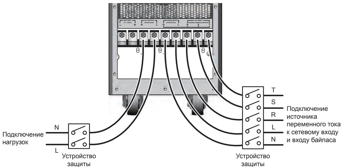
Рис. 6-9. Схема установки устройства защиты для ИБП с двумя входами
