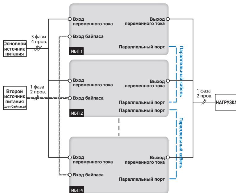
Рис. 6-18. Схема подключения в конфигурации с двумя входами
