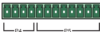
Рис. 4-7. Сухие контакты батареи
