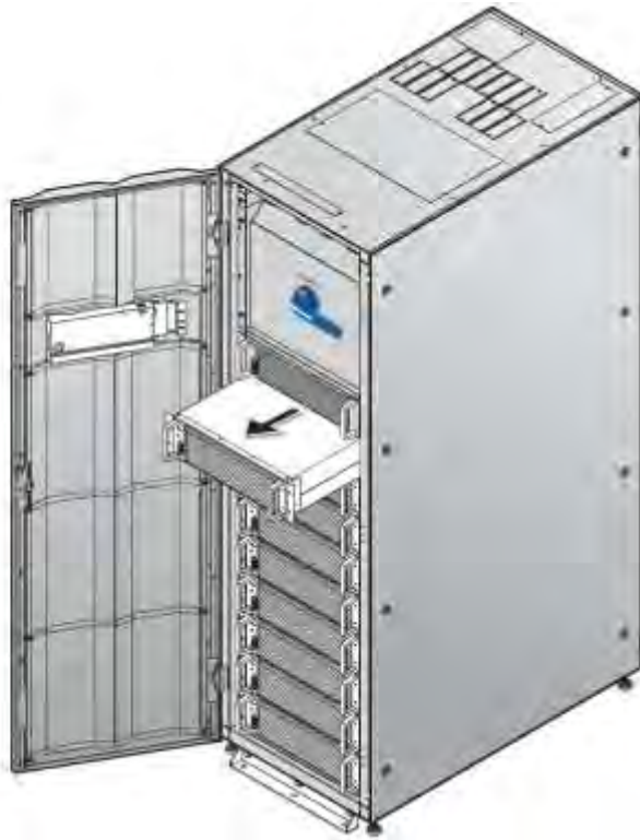
Рисунок 5-45: Демонтаж силового модуля
