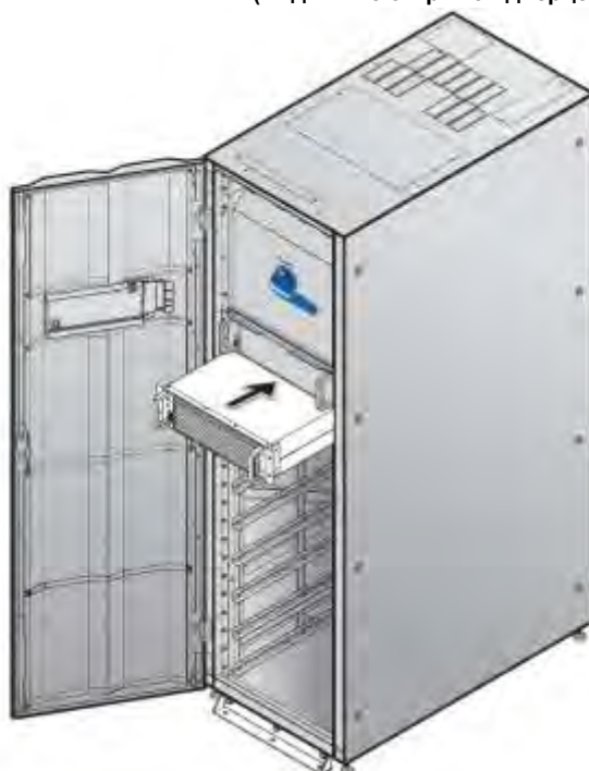
Рисунок 5-40: Установка силового модуля в ИБП
