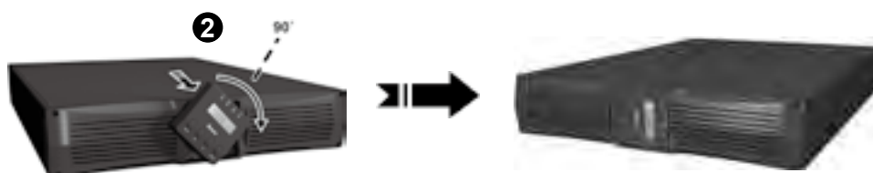
Рис. 3е. Перемещение ИБП в вертикальное положение
