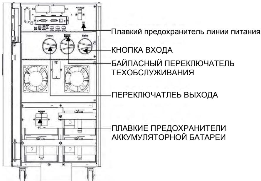
Рисунок 11 - Внутренний вид ИБП
