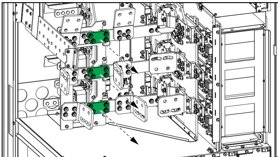
4. Снимите два верхних силовых модуля и самую левую панель-заглушку:
