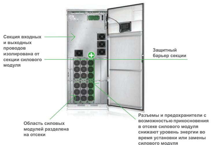
Galaxy VL с технологией Live Swap — это ответ Schneider Electric на национальные и местные правила техники безопасности при выполнении электротехнических работ. Подробнее см. в техническом документе № 13 [Минимизация риска поражения электрическим током во время замены оборудования под напряжением](#) (Mitigating Electrical Risk While Swapping Energized Equipment).
