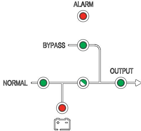
6. Подождите около 20 секунд, пока светодиод инвертора загорится ровным зеленым светом, ИБП автоматически перейдет из режима статического байпаса в нормальный режим.
