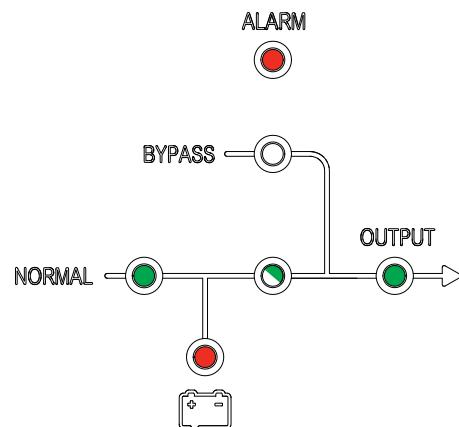
5. Когда светодиод инвертора загорится ровным зеленым светом, ИБП автоматически перейдет из режима статического байпаса в нормальный режим и присоединится к работающей параллельной системе.
