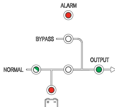
4. Когда светодиод выпрямителя загорится ровным зеленым светом, ИБП перейдет в режим статического байпаса.
