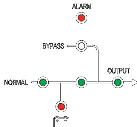
6. Установите батарейный автомат ВВ на ИБП в положение ВКЛ (замкнут).
