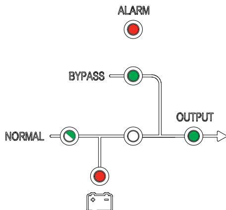
5. Когда светодиод выпрямителя загорится ровным зеленым светом, инвертор синхронизируется с байпасом.
