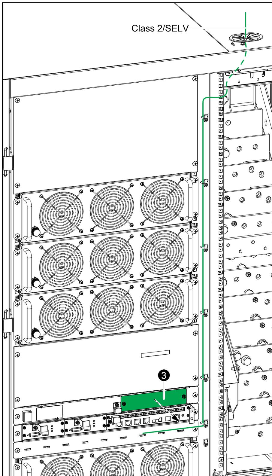
3. Установите на место защитную крышку перед клеммами non-Class 2/ non-SELV.
