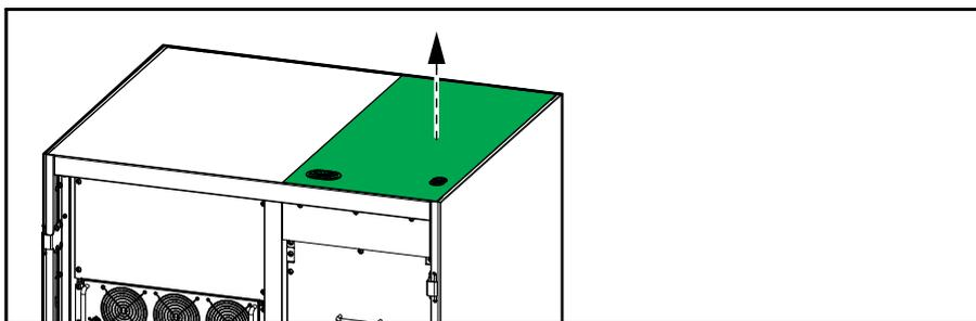
3. Просверлите или пробейте отверстия под кабели питания в верхней панели.
