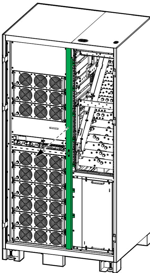
2. Проложите сигнальные провода Class 2/SELV через верхнее левое входное отверстие и вниз вдоль передней панели к точкам подключения.
