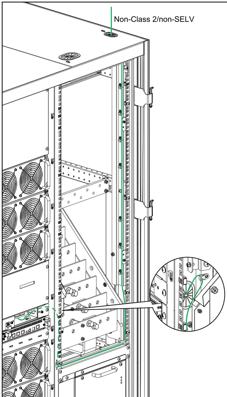
5. Закрепите сигнальные провода с помощью кабельной стяжки, как показано на схеме.
