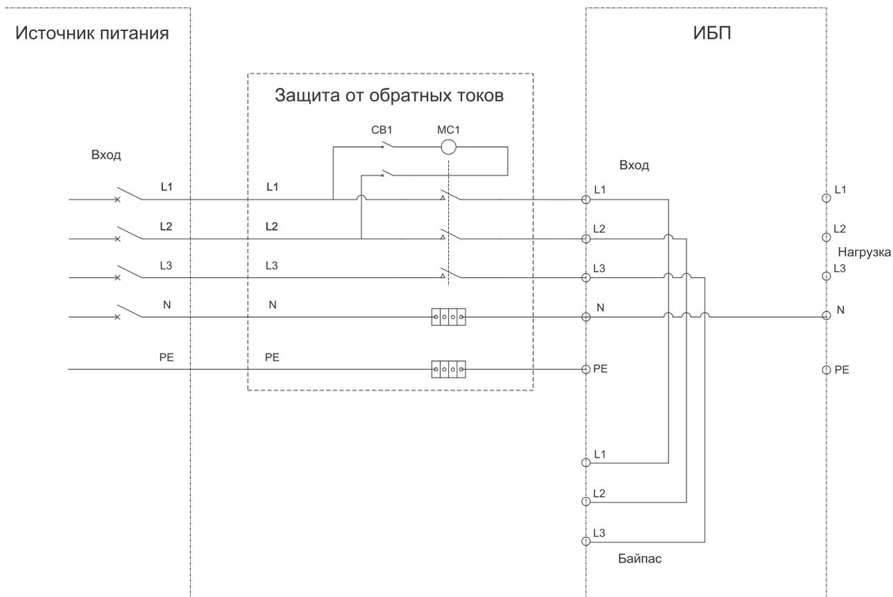
**ИБП с двойным вводом питания и внешнее устройство разъединения**
