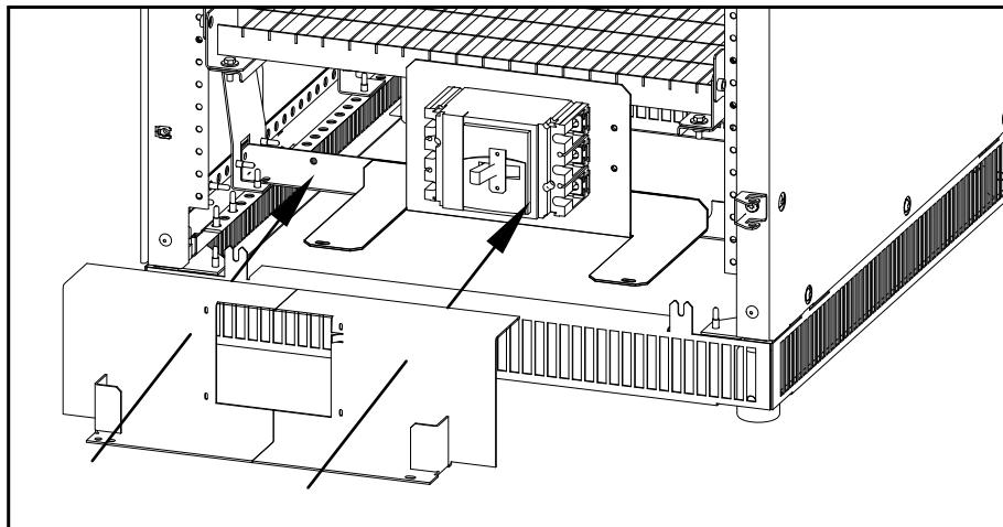
8. Установите повторно металлическую панель и угловые треугольники, если они ранее были сняты.
