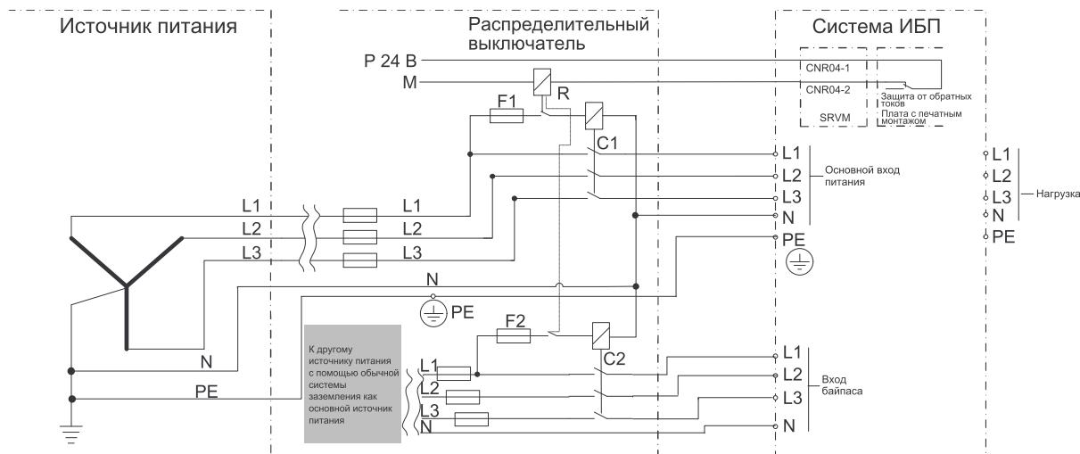
**Рис. 4. Двойное питание, ИБП 3:1 и внешнее устройство разъединения**
