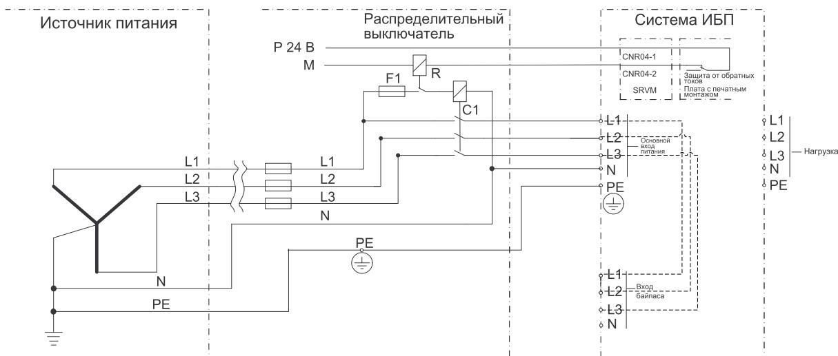
**Рис. 2. Одинарное питание, ИБП 3:1 и внешнее устройство разъединения**
