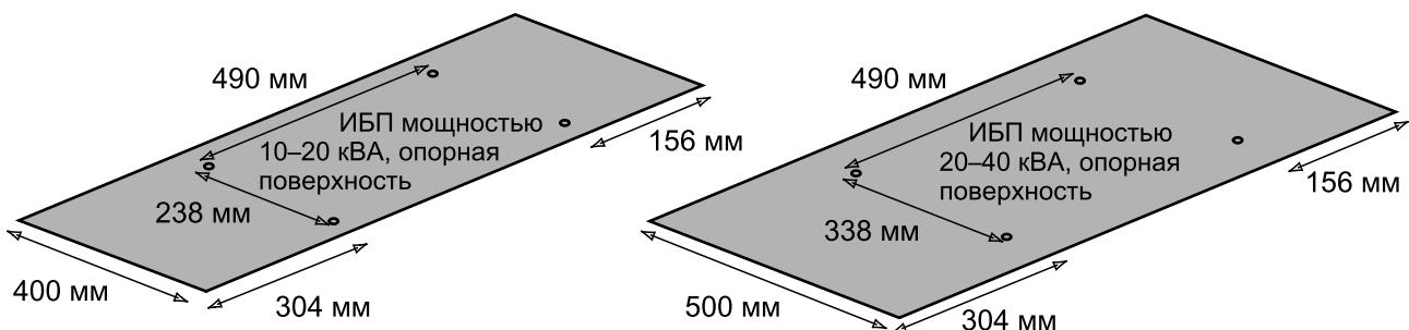
**3. Установите ИБП между четырех напольных болтов.**
