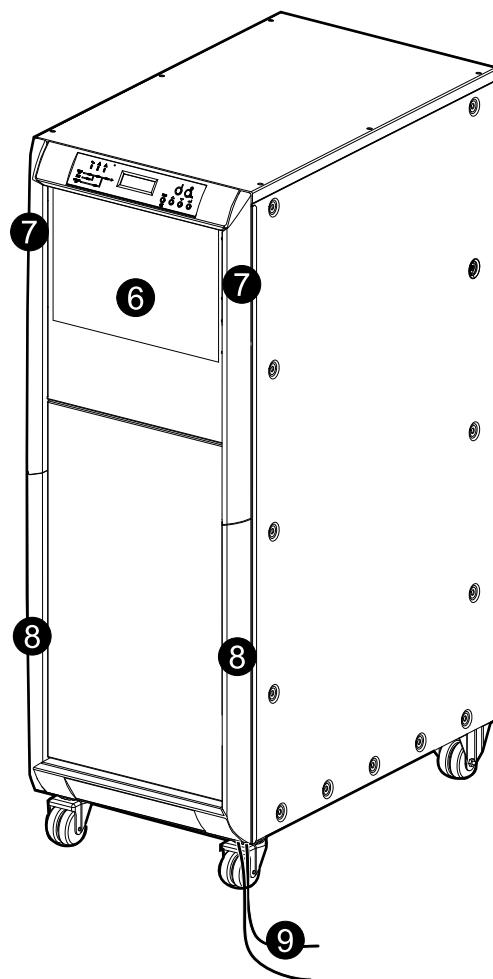
**Подключите кабель аварийного выключателя питания к ИБП**
