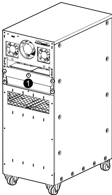
2. Ослабьте два винта и снимите пластиковую крышку.
