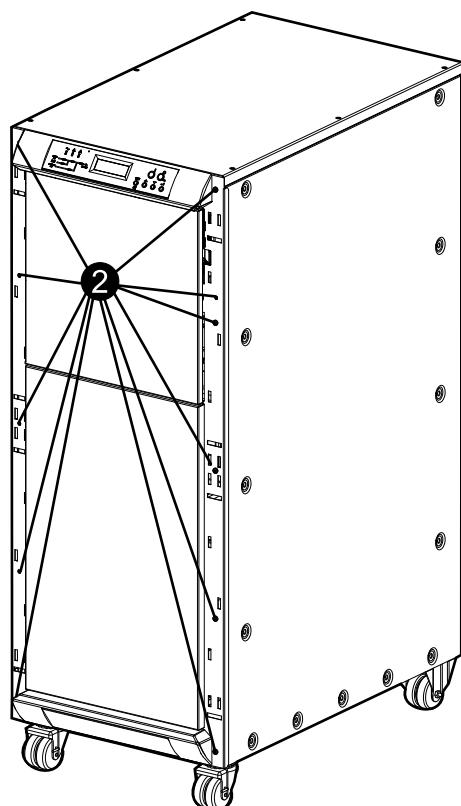
3. Наклоните переднюю крышку и отсоедините плоский кабель, соединяющий дисплей и шкаф ИБП.
