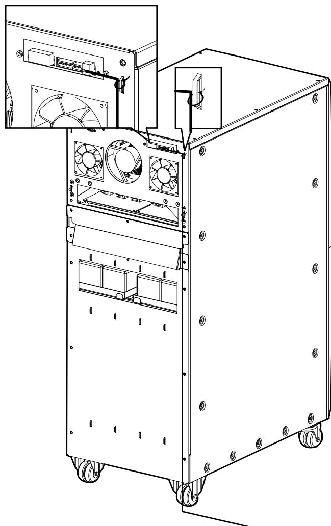
2. Подключите аварийный выключатель питания к контакту с помощью экранированного кабеля (не входит в комплект). Подключение по умолчанию закрыто двумя фиксаторами.
