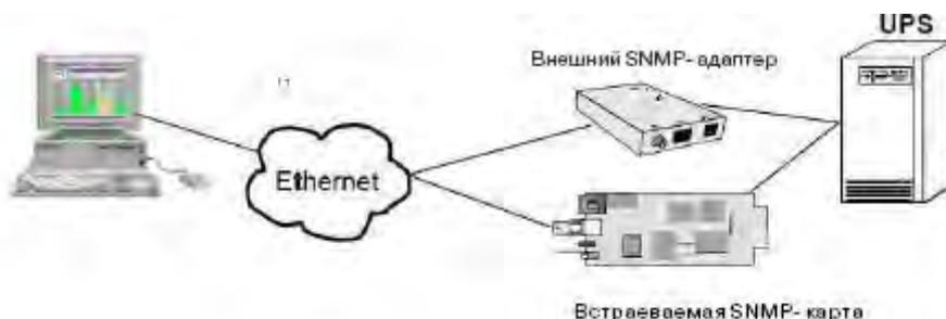
Адаптер может быть сконфигурирован через Telnet, HTTP (Веб-браузер) или последовательное соединение (Терминал). Для нормальной работы требуется, по крайней мере, одно сетевое подключение (Ethernet).
