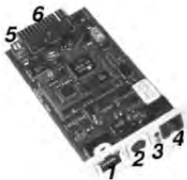
Рис. 1.5.2. Внутренний адаптер SNMP
