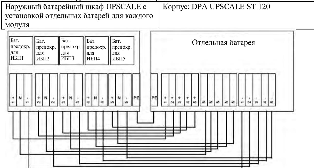
Рис. 3.2.3. Соединение наружных о батарей
