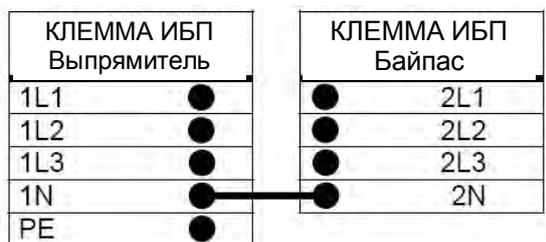
Для подключения двойной питающей линии следует подключить входные сетевые кабели электропитания к клемме ИБП согласно следующим таблицам:
