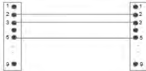
Рис. 1.1. Соединительный кабель – последовательный порт для ПК с 9-выводным соединителем
