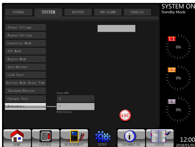
Figure 4.20 Redondance avec deux appareils
