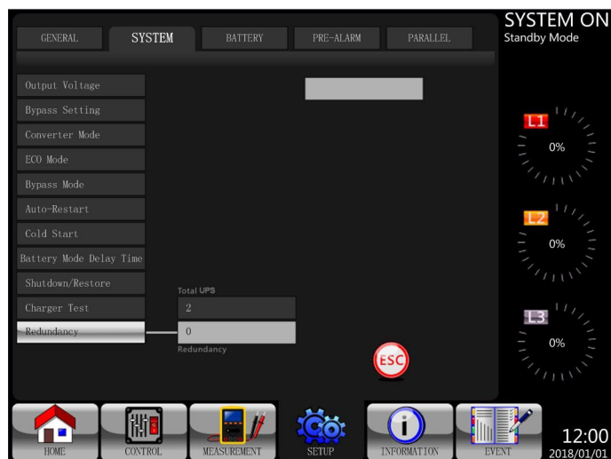
Figure 4.19 Mise en parallèle de deux appareils
