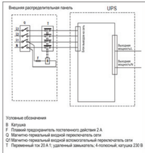
Рис. 6-5 Модель 10 кВА Компакт и внешнее изолирующее устройство
