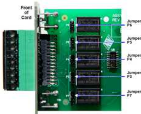
Figura 8-9 Ubicación y numeración de los jumpers
