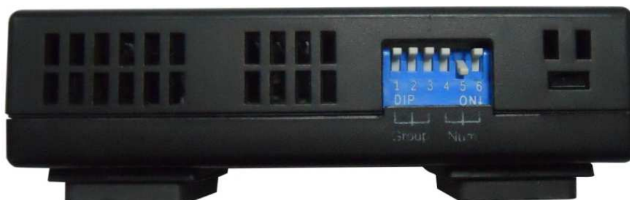
Figura 8-6 Ajustes del interruptor DIP del sensor de temperatura
