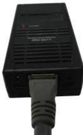
Figura 8-5 Conexión de la tarjeta UF-RS485 al sensor de temperatura de la batería
