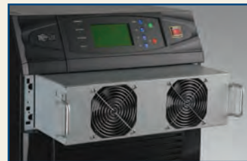
Модуль с резервной мощностью в 20 кВА
